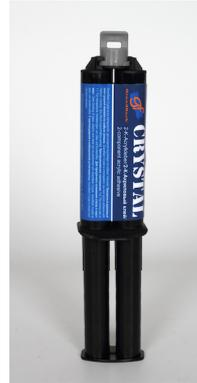
**GRANDFLASH Crystal** представляет собой двухкомпонентный прозрачный акриловый клей, со слабым запахом и средней вязкостью, с очень хорошей устойчивостью к ударам и вибрации. Время открытой выдержки составляет прим. 3 мин., фиксирование прим. 5 Minuten. Отверждение: 24 час. Температурная устойчивость от -40 до + 80°C.
